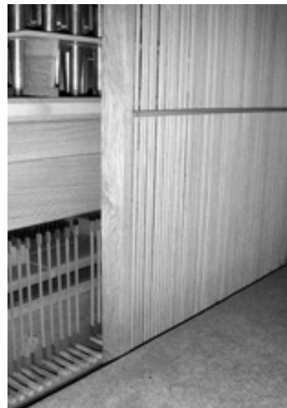
Teil der mechanischen Traktur: Holzleistchen (Abstrakte) führen über Gelenke von der Taste zum Pfeifenventil und ermöglichen ein superpräzises Spiel
