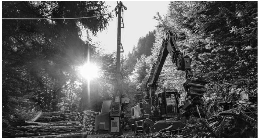
Mobilseilkran/ maschinelles Aufrüsten auf Lagerplatz
